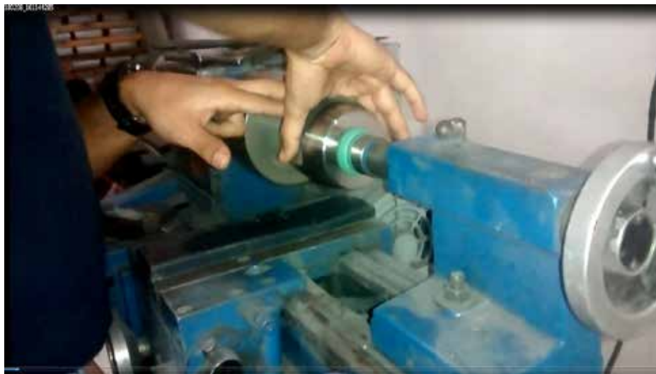
Figura 36. Operario cubre el rodillo con la mano descubierta Fuente: E. Barrada y D. Bravo (2018).
