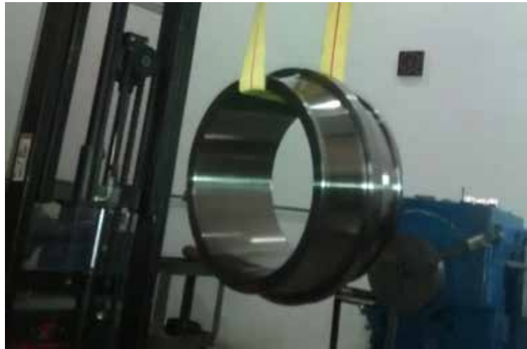
Figura 26. Traslado de aro externo a mesa de armado Fuente: E. Barrada y D. Bravo (2018)
