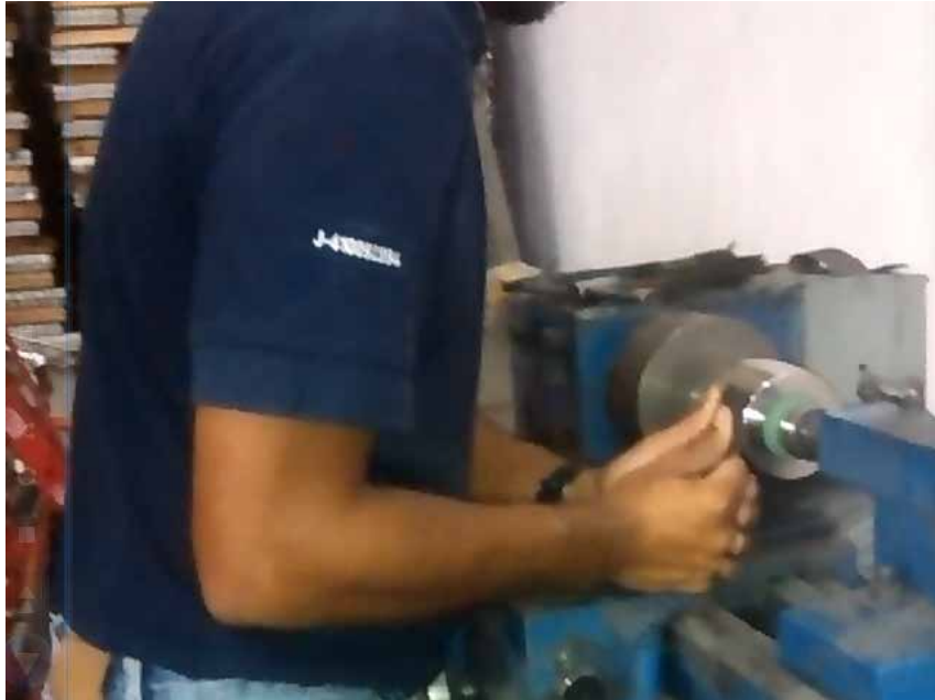
Figura 38. Posición alternativa de pulido de rodillos Fuente: E. Barrada y D. Bravo (2018).
