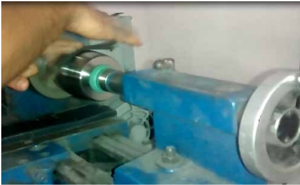
Figura 35. Colocación de la lija en el rodillo Fuente: E. Barrada y D. Bravo (2018).
