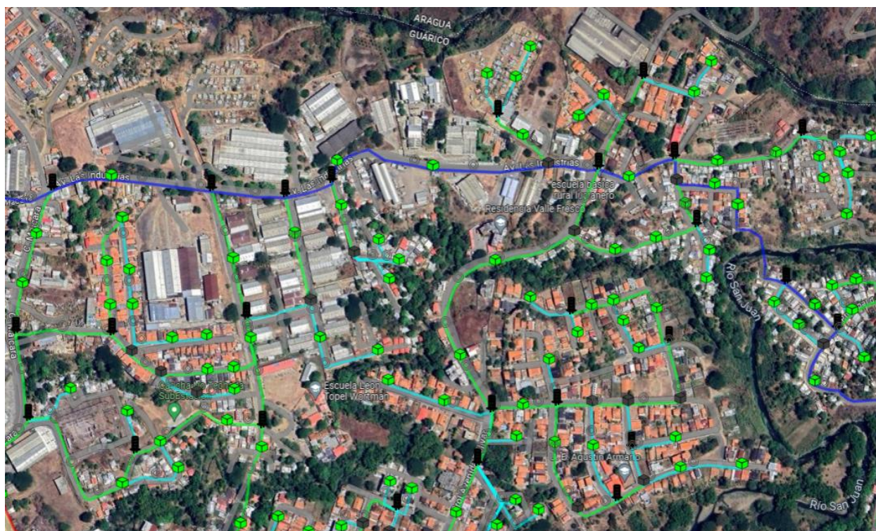
Figura 146. Red de fibra óptica Casco Industrial, Urb. Las Abejitas I y II. Fuente: Ramírez, Lugo. (2023)
