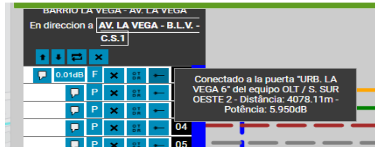
Figura 190. Potencia del PON utilizado en la Urb. La Vega. Fuente: Ramírez, Lugo. (2023)
