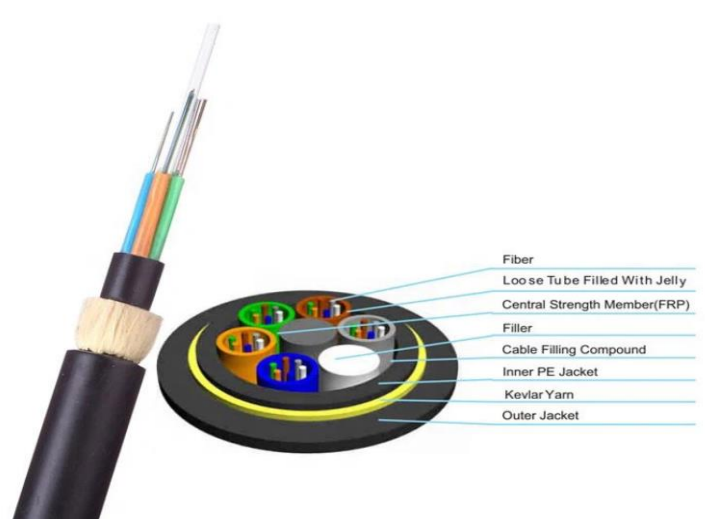
Figura 27. Composición de Fibra ADSS.
