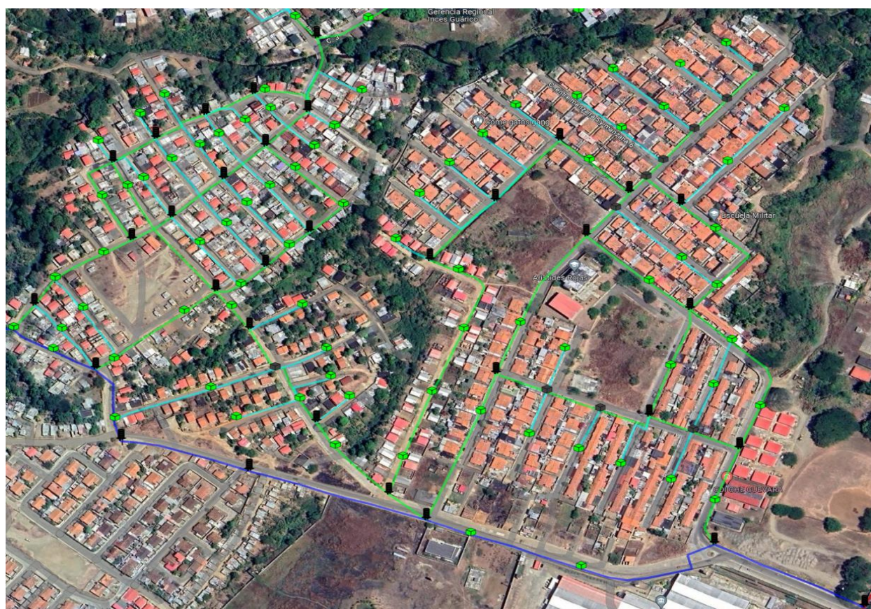
Figura 158. Red de fibra óptica Urb. Altamira. Fuente: Ramírez, Lugo. (2023)
