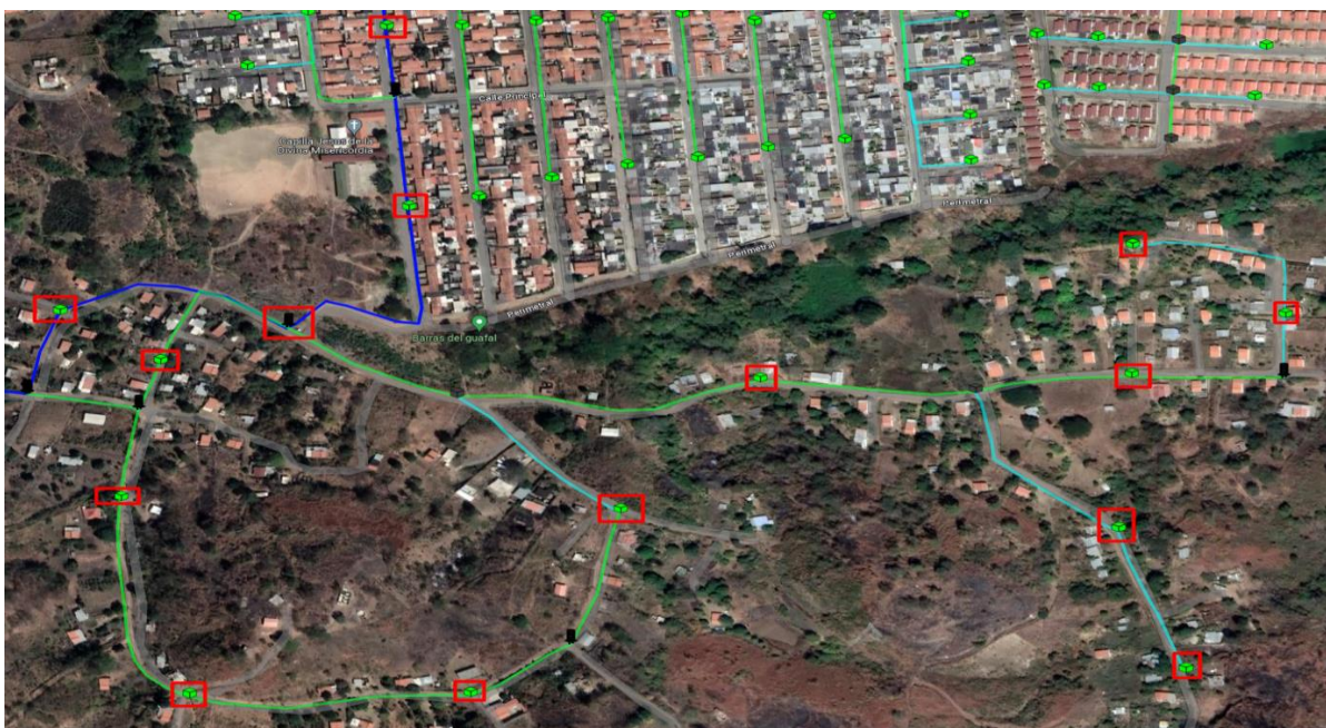
Figura 195. Cajas con cobertura para combinación de Splitter 1:16 – 1:8. Fuente: Ramírez, Lugo. (2023)
