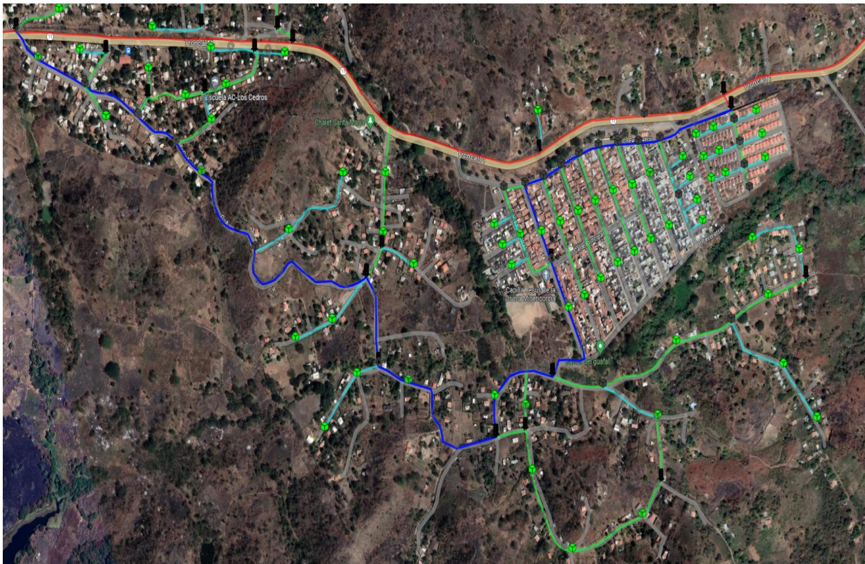
Figura 152. Red de fibra óptica B. La Cumbre E.2 y E.3, Urb. El Guafal Etapa 1, 2 y 3. Fuente: Ramírez, Lugo. (2023)
