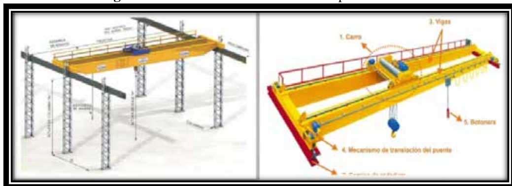
Figura 7: Estructura De Las Grúas Tipo Puente
