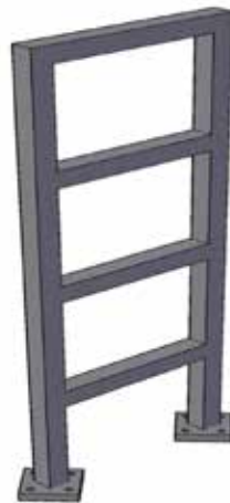
Figura 10. Pipe rack tipo litera.
