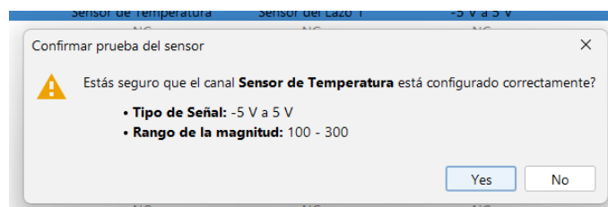
Figura 70: Ventana de Confirmación de la Verificación de un Sensor
