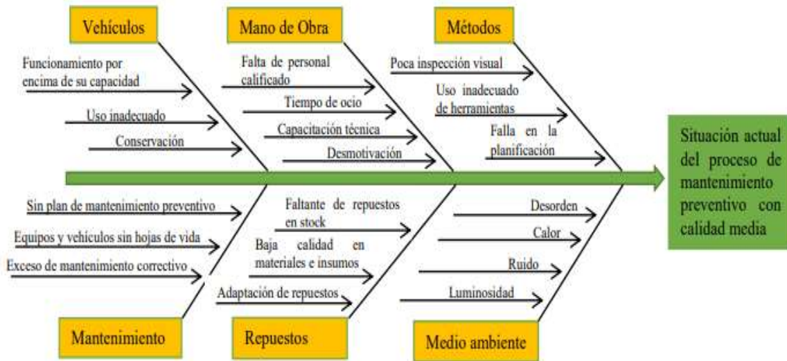
Figura 17. Diagrama causa-efecto de la situación actual del proceso de Mantenimiento Preventivo
