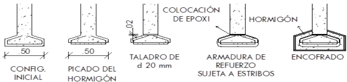
Figura 38: Proceso de reparación del eje inferior de la viga.
