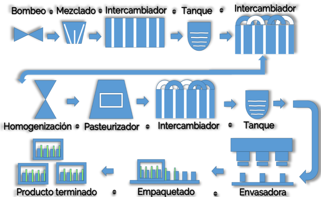
Figura 2 Esquema del proceso de la línea kaito de Naturalyst S.A. Fuente: Procesadora Naturalyst S.A. (2021)
