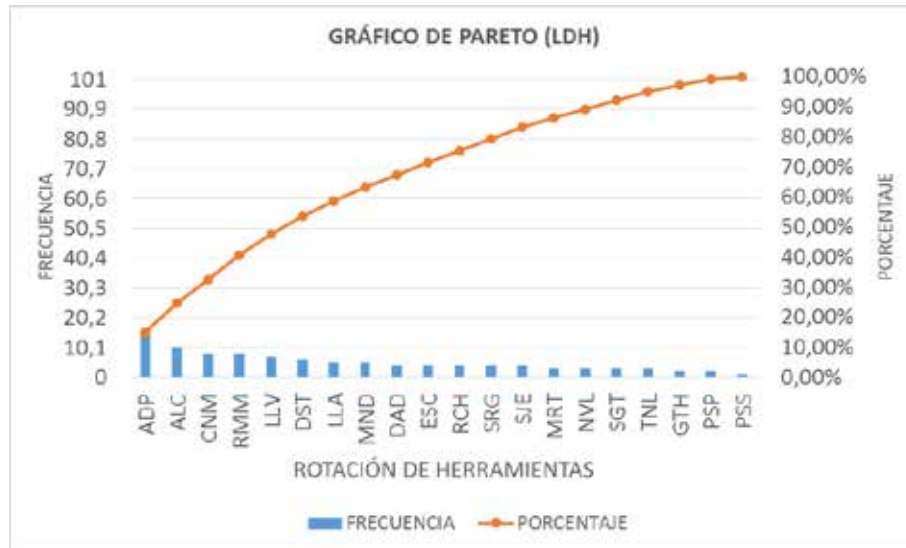
Gráfico 2: Gráfico de Pareto de la rotación de herramientas según análisis ABC Autor: Ferrer y Martínez (2021)
