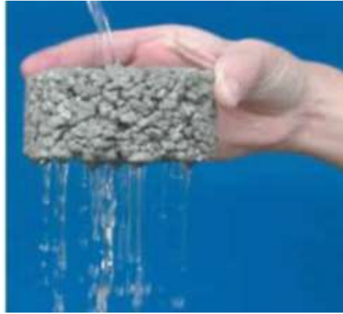
Figura 1. La estructura vacía del concreto permeable
