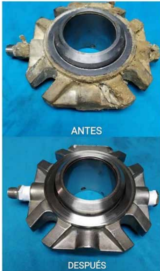
Figura 10. Sello mecánico reparado
