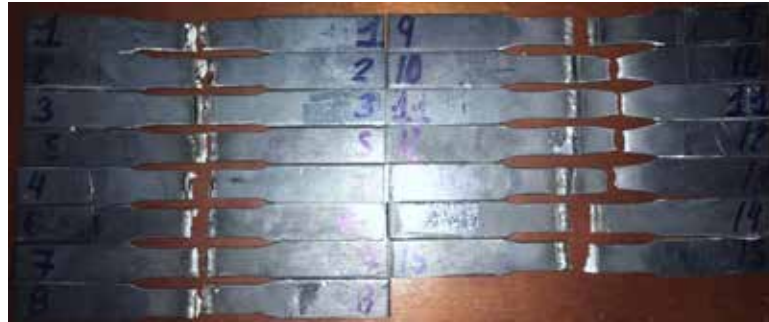
Figura 31. Probetas soldadas utilizadas en el ensayo de tracción.
