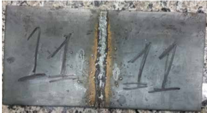
Figura 27. Muestra después del proceso de soldadura.
