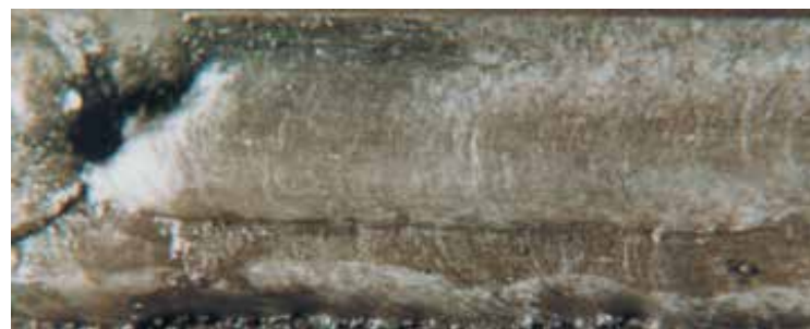
Figura 8. Fusión Incompleta entre soldadura y metal base.
