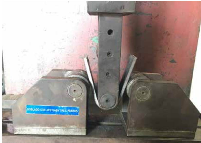
Figura 18. Ensayo de doblado con apoyo en tres puntos.
