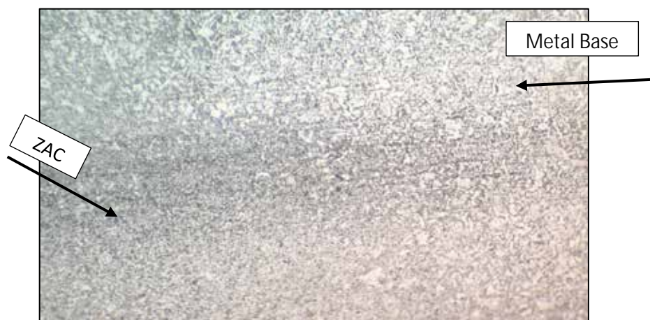
Figura 43. Límite entre la zona afectada por el calor y la zona del metal base de la muestra 5 a 100x.
