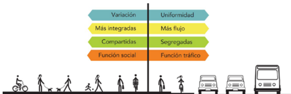
Figura 63: Segregación, flujo y función de tráfico vs integración y función social, planificación de ciclo-infraestructura.
