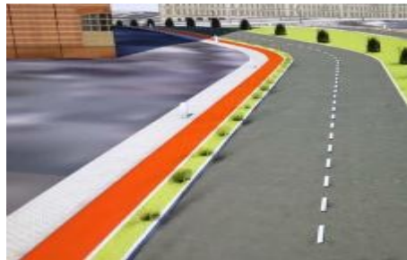
Figura 62: Ciclo-acera propuesta con separador lateral como segregador vial.
