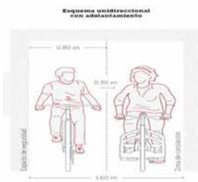
Figura 58: Esquema Unidireccional con Adelantamiento, Dimensiones Mínimas.
