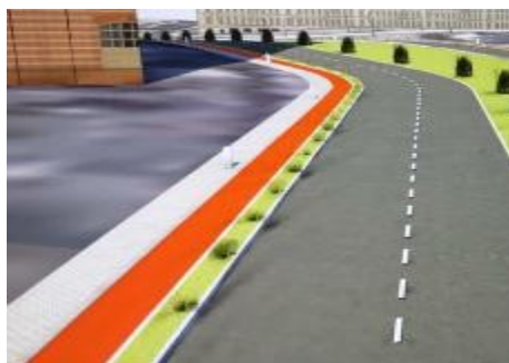
Figura 67: Cicloacera propuesta con separador lateral como segregador vial.
