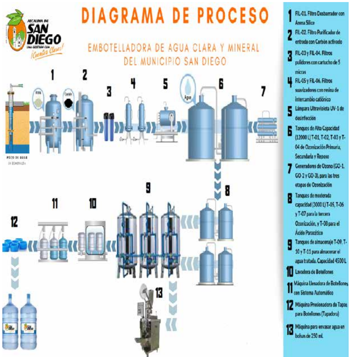
Figura 3. Diagrama de Proceso Empresa Municipal de Agua Clara y Mineral Fuente: Farfán, Rebolledo (2.019)
