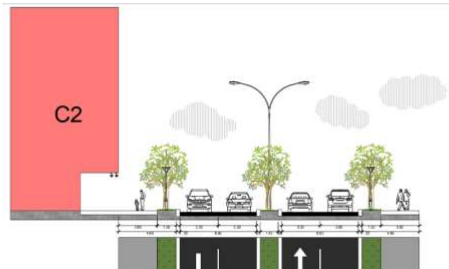
Figura 28. Propuesta del perfil de Las cuatro avenidas. Fuente: Montilla y otros (2023).
