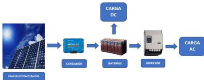
Figura 12. Sistema fotovoltaico autónomo (SAMUEL ESTEBAN ORTIZ, 2018)
