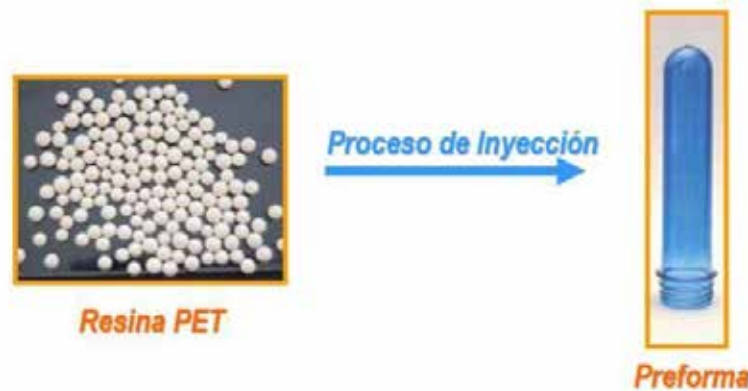
Figura 3 Proceso de Inyección de Preformas PET.
