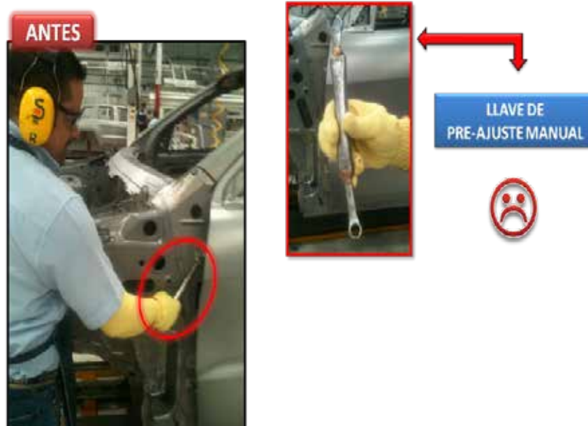
Figura 43: Herramienta 13 mm utilizada para desajustar los tornillos.
