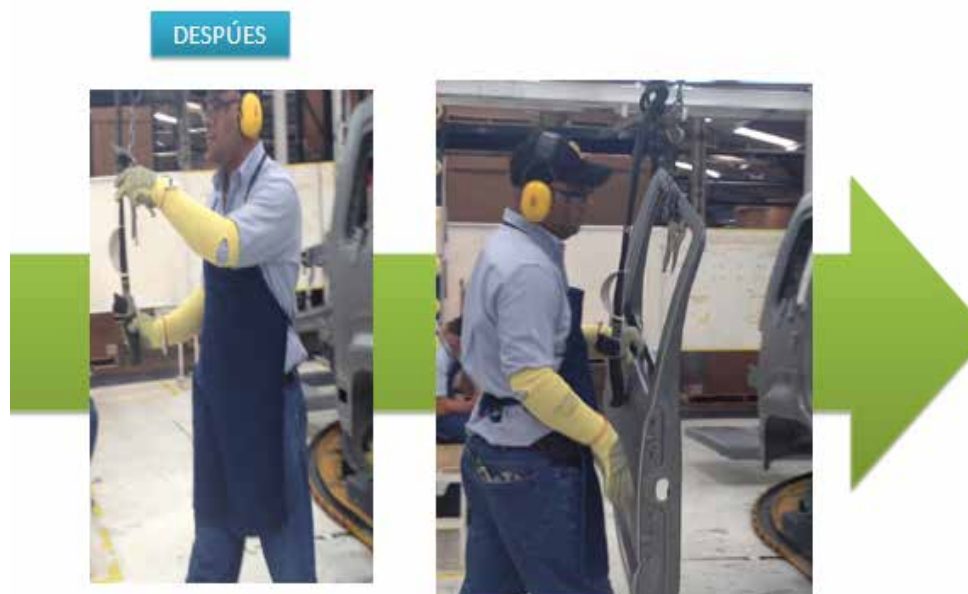
Figura 34: Actividad después de la implementación de la grúa cero gravedad.
