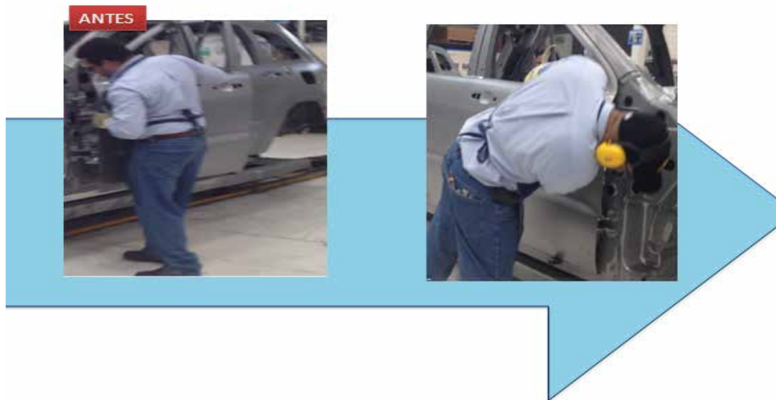
Figura 38: Operario sosteniendo la puerta para el pre-encaje.
