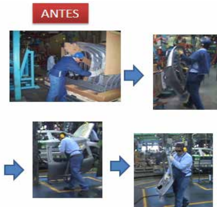
Figura 31: la Situación actual de búsqueda de las puertas para el ensamblaje.
