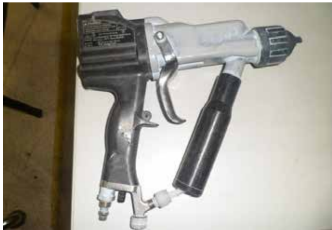
Figura 13: Pistola que se utilizan para pintar los vehículos
