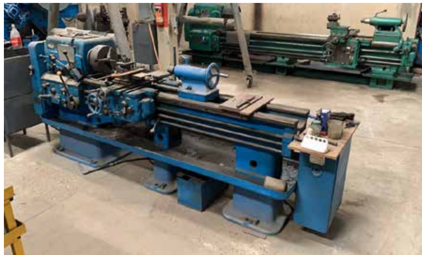
Figura 8: Torno para cilindros (cilindrado y refrentado de tubos) Fuente: Chacón, S.; Pérez, E. (2019).
