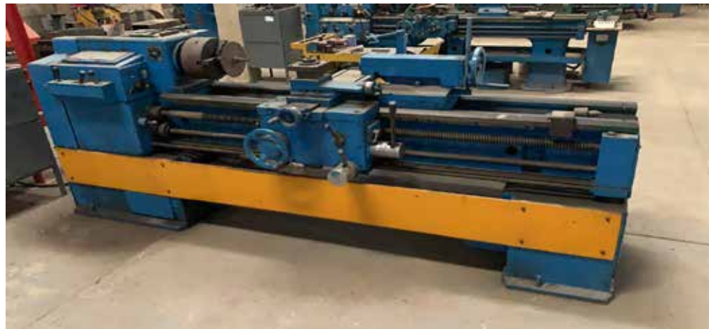
Figura 10: Torno para tapas (cilindrado de tapas). Fuente: Chacón, S.; Pérez, E. (2019).
