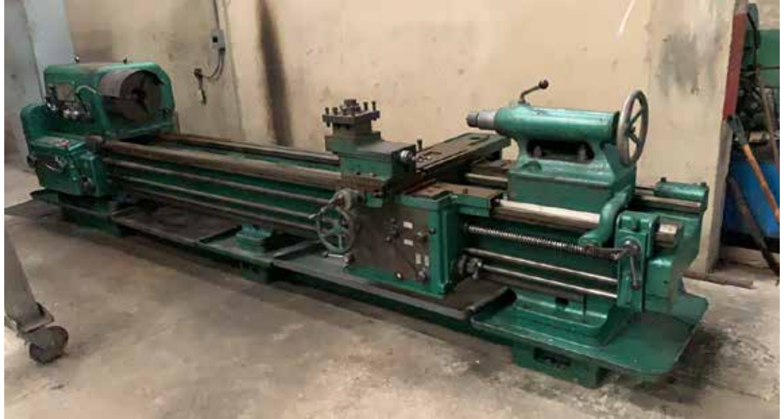
Figura 11: Torno para ejes (cilindrado y refrentado) Fuente: Chacón, S.; Pérez, E. (2019)
