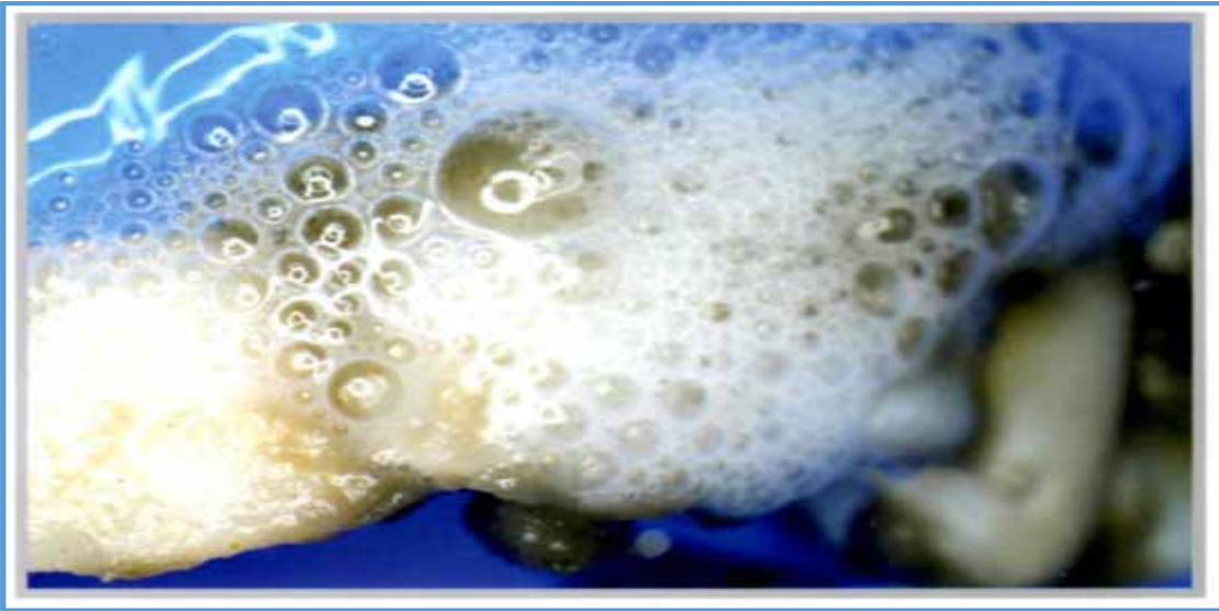
Figura 5. Lavado con una mezcla de agua destilada y carbonato de sodio para desactivar el ácido (35)
