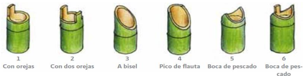
Figura 19 Cortes más utilizados en uniones
