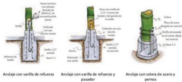
Figura 20 Uniones en cimentación
