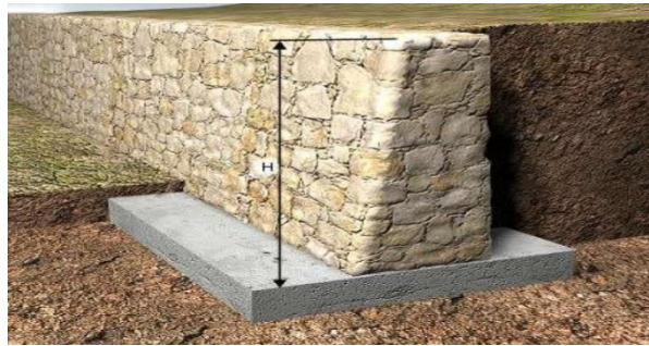
Figura 2 Muro de Contención http://www.construmatica.com
