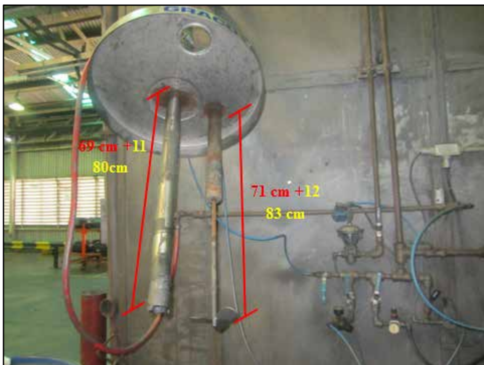
Figura 8: Tubo ajustado a la longitud propuesta (2018)
