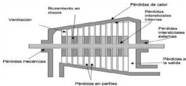
Figura 3: Pérdidas de energía en una turbina de vapor.
