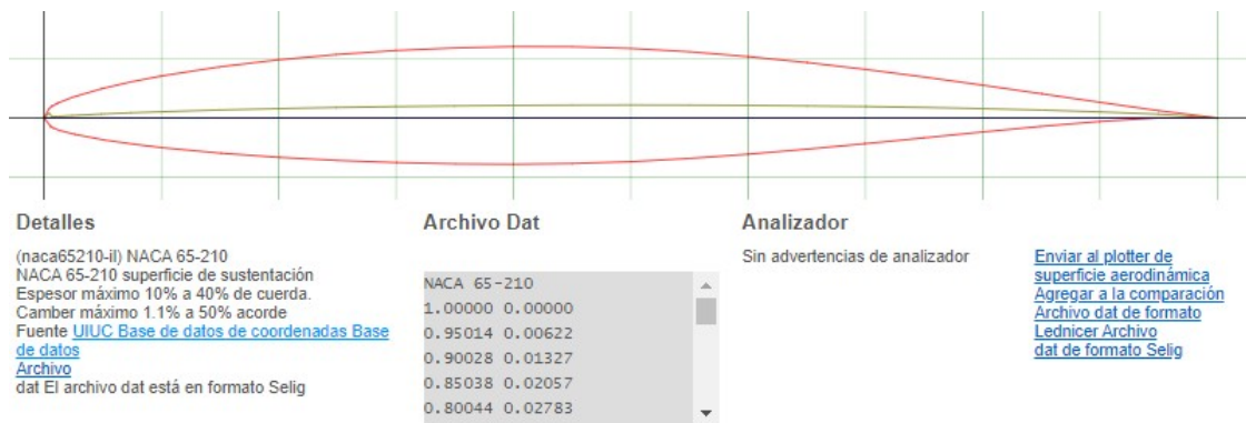
Figura 23. Perfil de alabe NACA 65-210.
