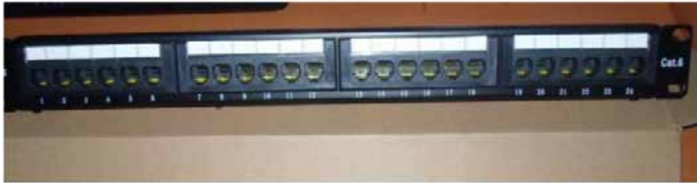
Figura 32. Patchpanel RJ-45 con blindaje categoria 6 frontal
