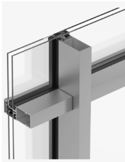
Figura 22. Detalle de muro cortina. Fuente: https://www.nicepng.com/ourpic/u2w7r5r5u2r5i1a9_downloads-piel-de-vidrio-detalle-constructivo/ (2021)
