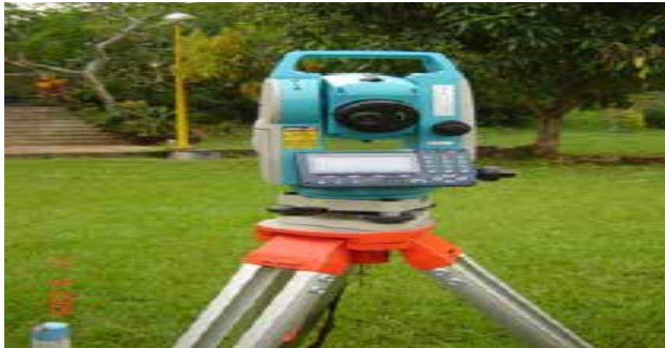
Figura 7. Estación Total SET 630 RK- Sokkia.
