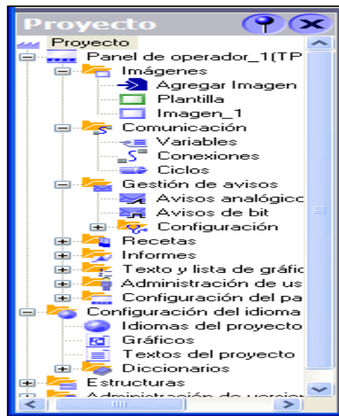
Figura 40. Ventana de proyecto del WinCC Flexible
