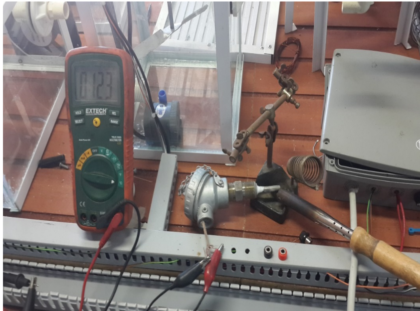
Figura 91. Calibración de la Termocupla.
