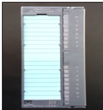
Figura 9: Módulo de entradas digitales DI SM 321.
