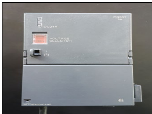
Figura 13. Fuente de alimentación PS 307 5 A.
