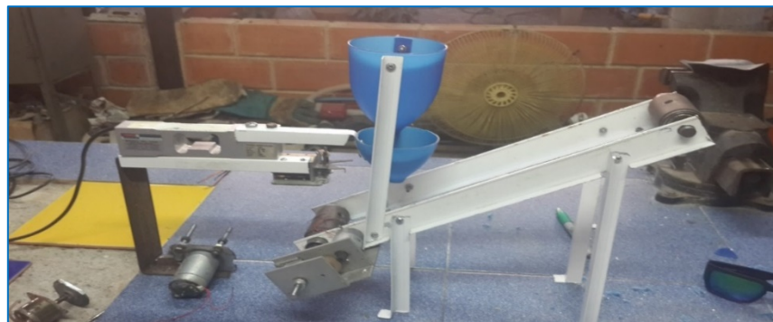
Figura 78. Instalación de la celda de carga en estructura fija.
