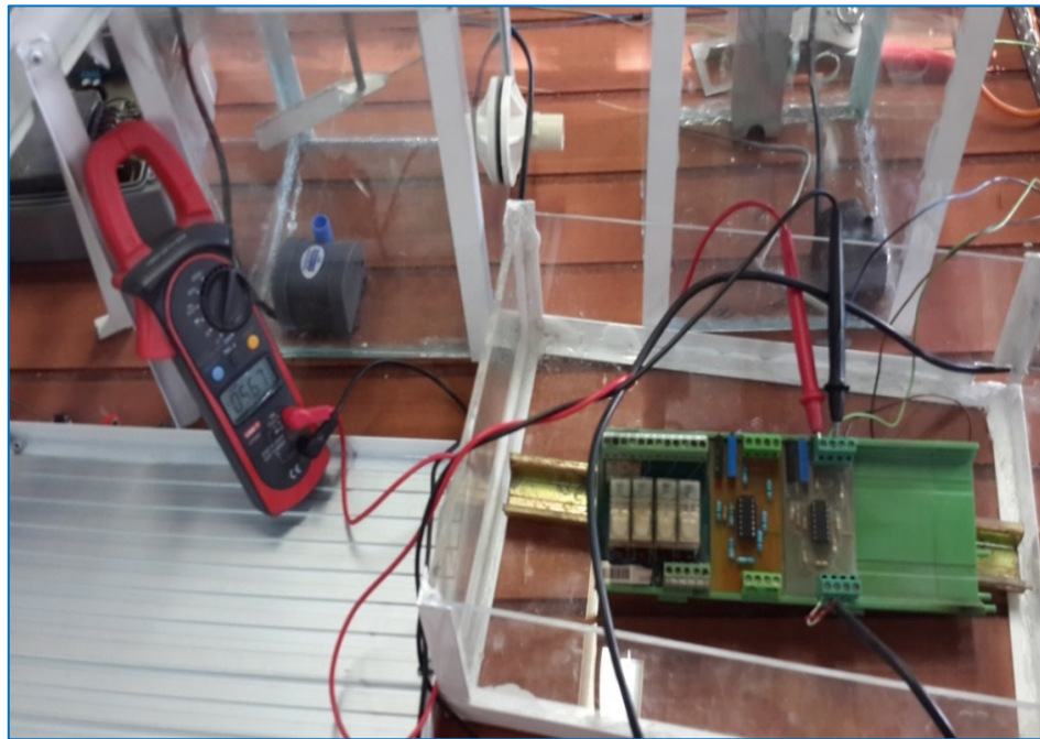
Figura 89. Calibración de la tarjeta de amplificación de la celda de carga
