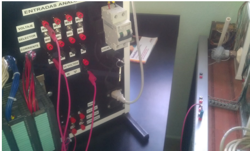
Figura F-12: Ejemplo de conexión de las entradas analógicas.
