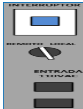
Figura 73: Breaker de control.
