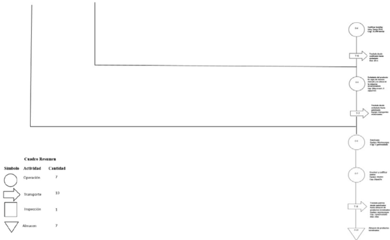
Figura 12. Diagrama de Operaciones del Proceso de llenado en la línea N° 4 de cloro en presentación de 1 litro.
