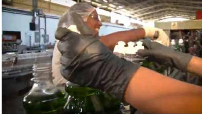
Figura 6. Proceso de tapado de los envases de manera manual por los operadores.
