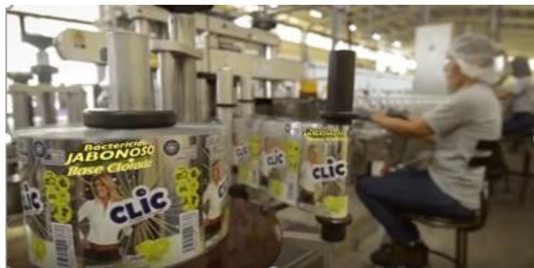
Figura 4. Proceso de etiquetado de los envases por la etiquetadora. Fuente: Sánchez, María (2019).
