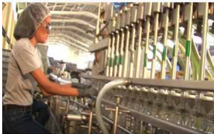
Figura 5. Proceso de llenado de los envases por la llenadora semiautomatizada
