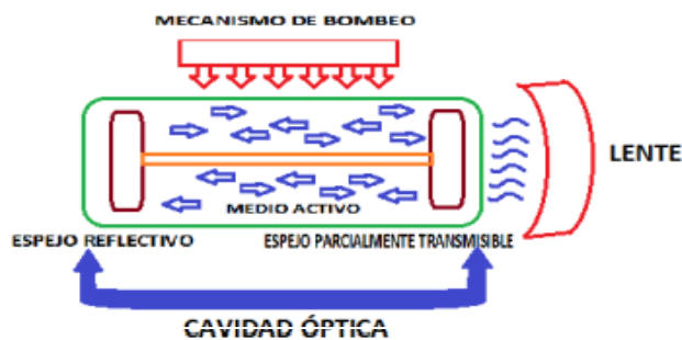
Figura 1. Elementos de la cavidad óptica que permiten la amplificación de la luz láser (12).
