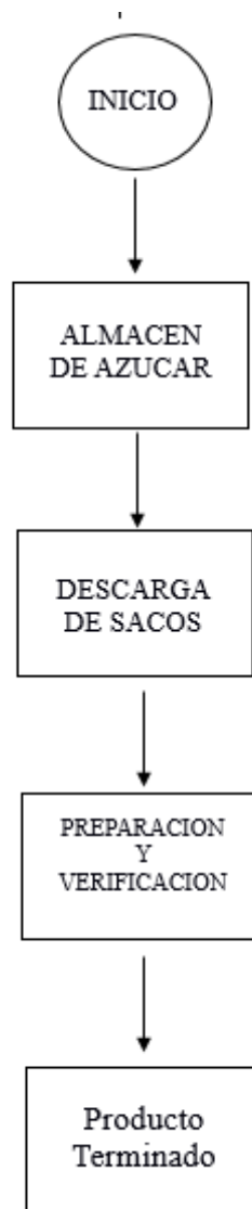
Figura 6. Diagrama de proceso, preparación de jarabe de azúcar
