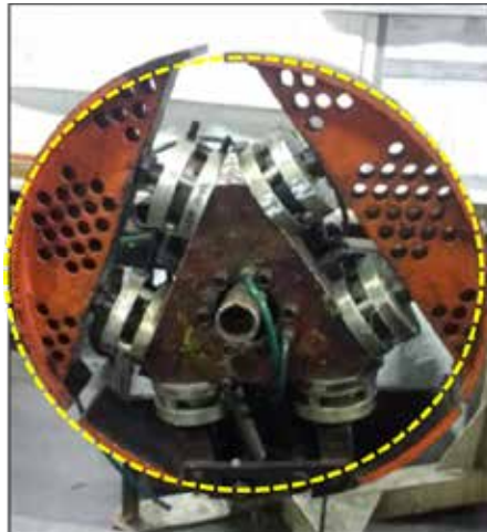
Figura 31: Horma con segmentos descalibrados
