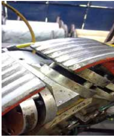
Figura 26: Segmentos de horma desgastados
