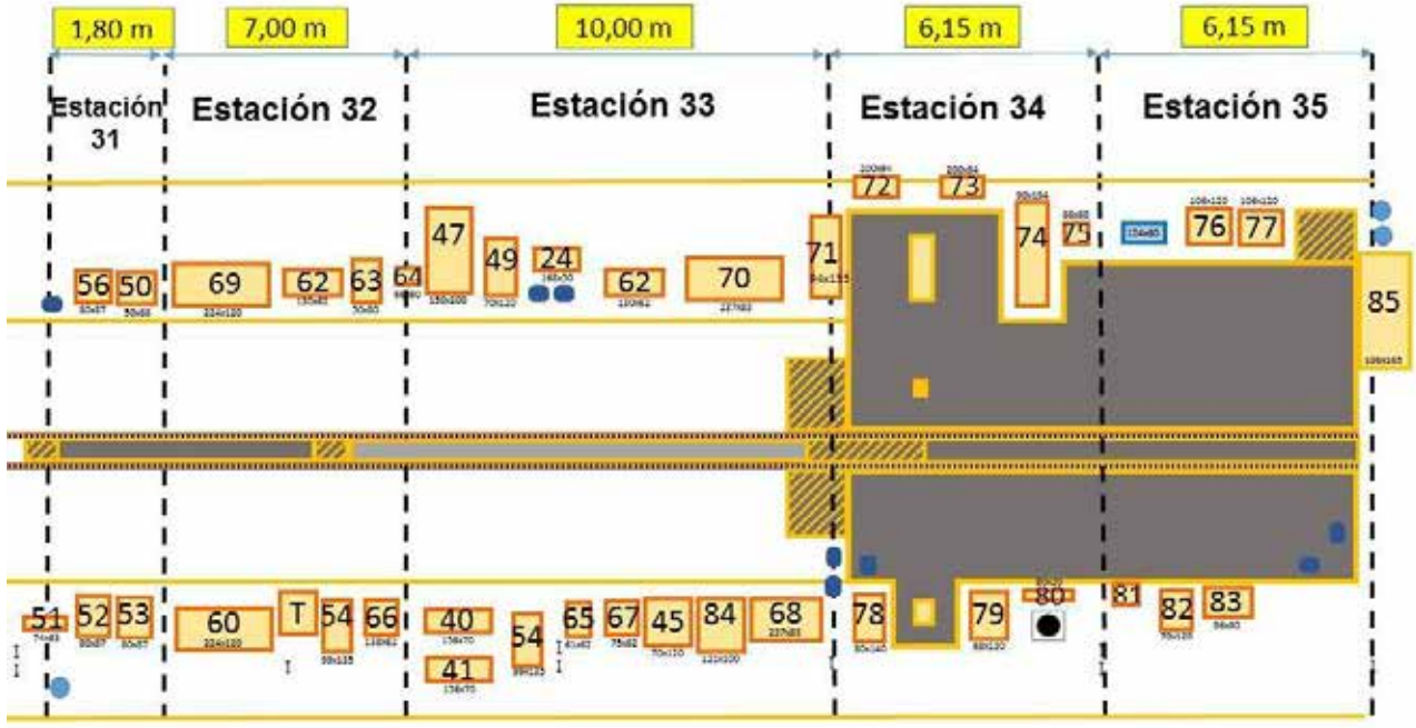
Figura 26: Nuevo LayOut de las estaciones 31, 32, 33, 34 y 35 de vestidura baja Fuente: Tellería, Fernandez (2016)
