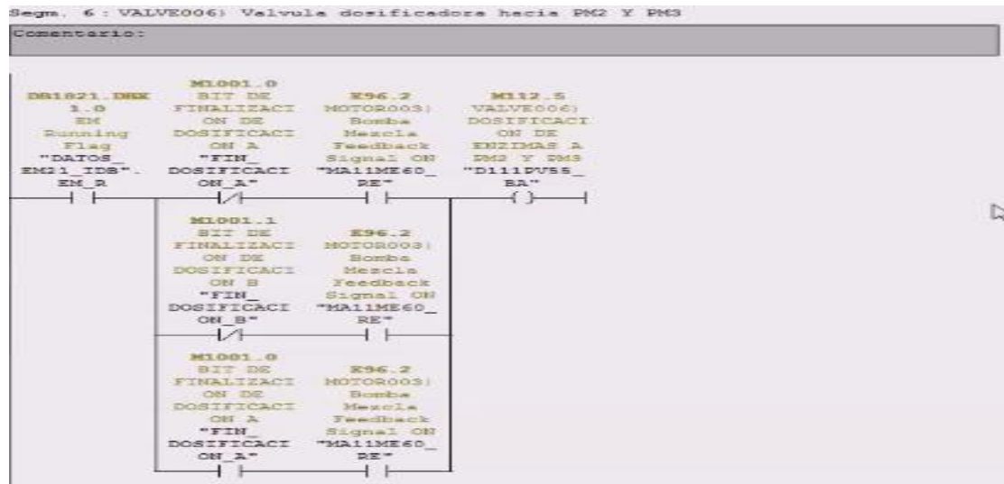
Figura 50 Apertura de válvulas que van a PM2 y PM3
