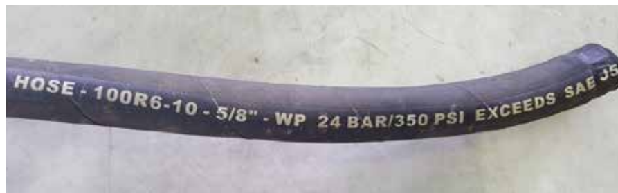
Figura 82. Descripción de las mangueras utilizadas en el circuito de calefacción.
