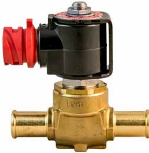
Figura 73. Válvula de control de flujo del refrigerante del motor usado para calentar el fluido de escape diésel. Proporcionada por Shaw Development.
