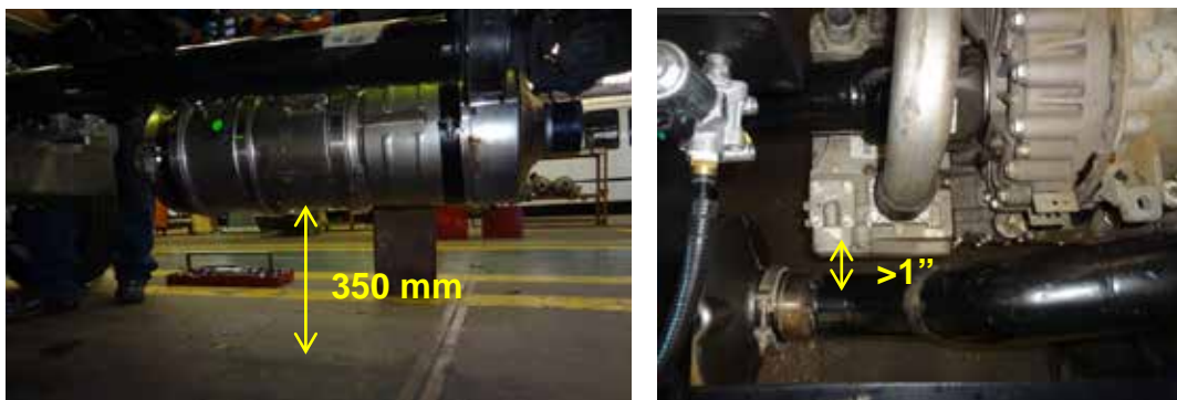
Figura 52. Altura de montaje del convertidor catalítico con respecto al suelo.
