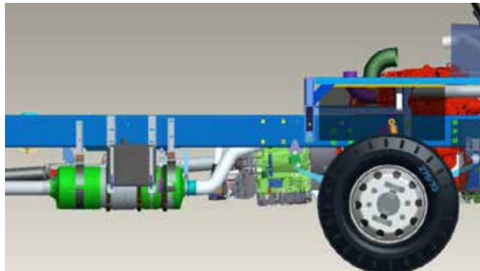
Figura 42. Vista lateral derecha del chasis del ENT-710 diseñado en Pro/ENGINEER, con enfoque al motor y sistema de postratamiento.
