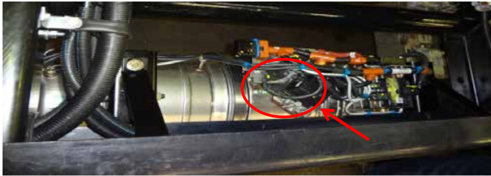
Figura 54. Posicionamiento del módulo de dosificación en el sistema de postratamiento con respecto a los otros componentes circundantes.
