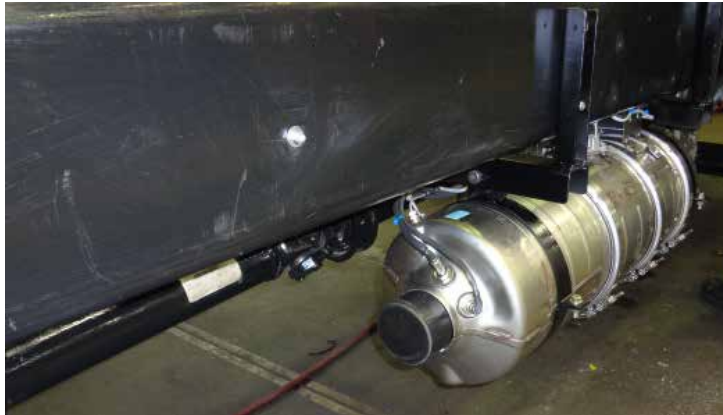
Figura 37. Inclinación del dispositivo de módulo único en posición de montaje, con respecto al eje vertical, donde se puede observar el montaje en físico.
