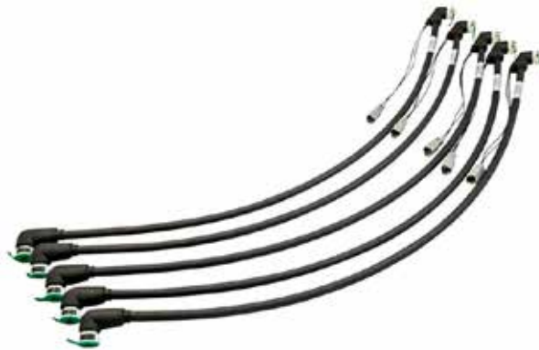
Figura 75. Mangueras de circulación del fluido de escape diésel con calefacción por resistencia eléctrica y conexiones rápidas SAE J2044. Proporcionada por Shaw Development.
