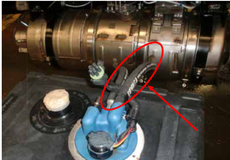
Figura 81. Detalle de la manguera utilizada en el circuito de tránsito del refrigerante del motor para la calefacción del sistema de dosificación, clasificación SAE 100r6 J517.
