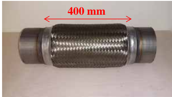
Figura 67. Flexible utilizado en la estructura del bajante de escape.
