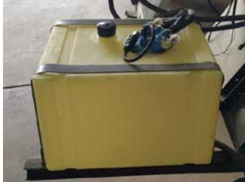
Figura 72. Tanque de urea seleccionado para la aplicación, de una capacidad de 10gal.
