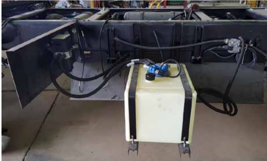
Figura 80. Montaje en desarrollo del sistema de dosificación con sus líneas de DEF.
