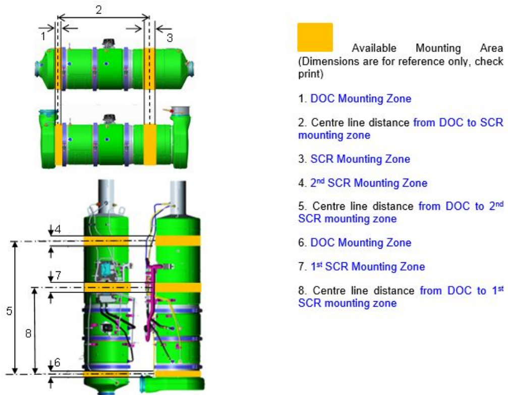
Figura 63. Sistema de montaje del dispositivo de módulo único.
