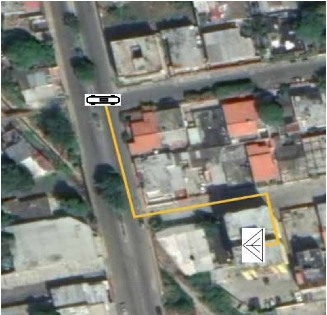
Figura 39: Recorrido desde la manga hasta el splitter en el edificio.
