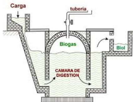
Figura 65 Detalle de Biodigestor , fuente: https://www.aboutespanol.com/que-es-un-biodigestor-3417683
