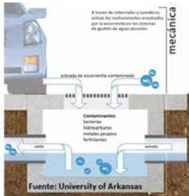
Figura 66 Recolección de Aguas Pluviales en el Estacionamiento, fuente:
