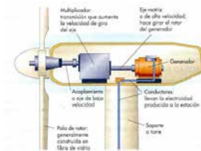
Figura 67 Detalle de Turbina Eólica, fuente: http://eeolicacsj.blogspot.com/p/partes-de-una-turbina-eolica.html
