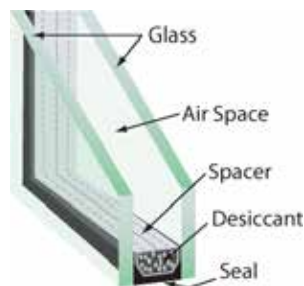
Figura 41 Detalle de Cristal doble cámara 6mm , fuente: http://www.na.es.sunguardglass.com/SpecificationsbrResources/TechnicalLibrary/TechnicalInformation/index.htm
