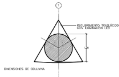
Figura 50 Detalle de Columna , fuente: La Autora (2017).
