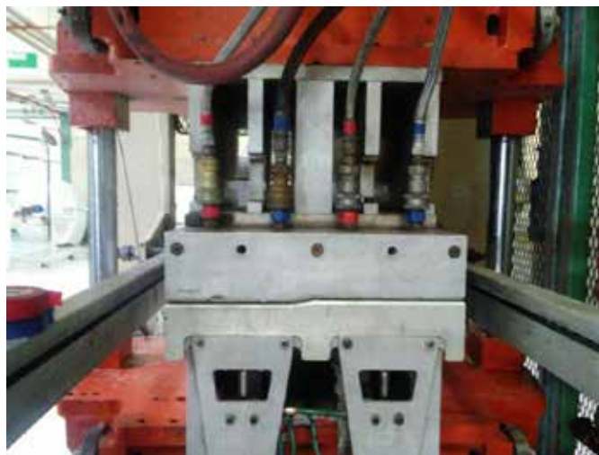
Figura 21. Identificación de las mangueras del sistema de enfriamiento Fuente: García W. (2018)
