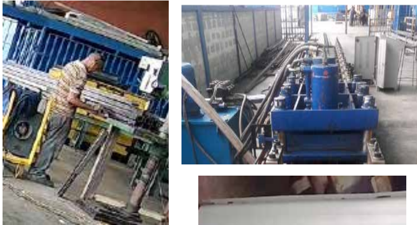
Figura 8: Maquina perfiladora (Roll Forming) y dobléz en L de lámina Autor: Ramírez, N. (2021)
