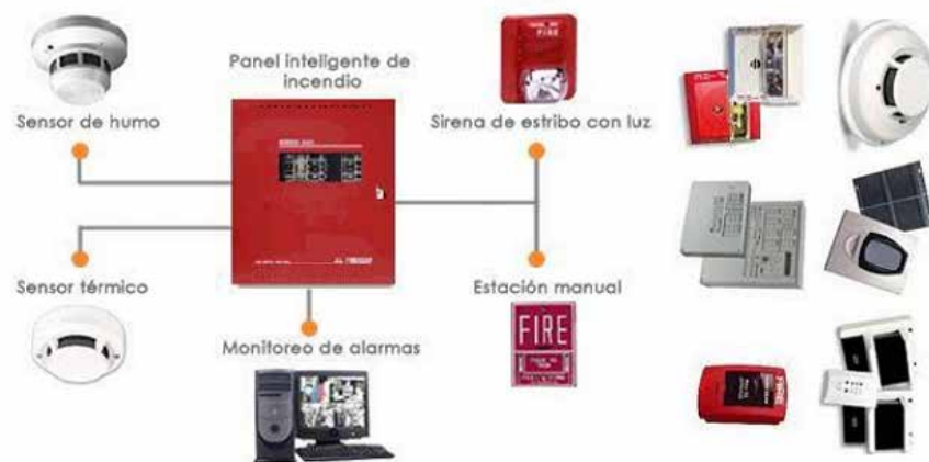
Figura 34. Sistemas contra incendio. Fuente: Google (2021)
