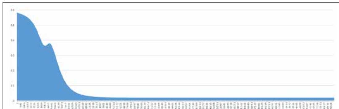
Figura 43: Grafica de error de aprendizaje de la Red Neuronal de la Figura 42 para un máximo de 50000 iteraciones permitidas. Fuente: Robert Perez (2020).
