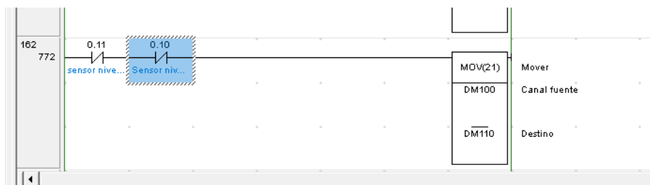
Figura 53. Sensor de nivel alto para tanque principal con jarabe.
