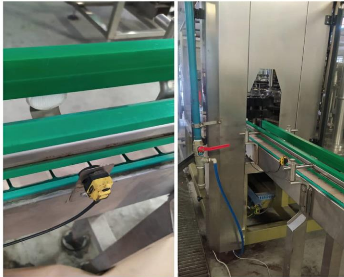
Figura 24. Sensor foto reflectivo para detectar botella en cinta final.
