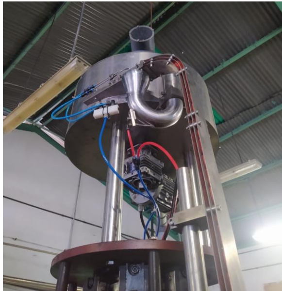
Figura 23. Sensor foto reflectivo para detectar el nivel de tapas en tanque de tapas.
