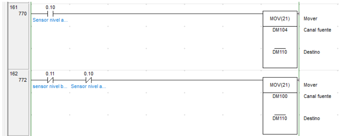
Figura 62. Sensor de nivel bajo (0.11) y alto (0.10) para el tanque 1.
