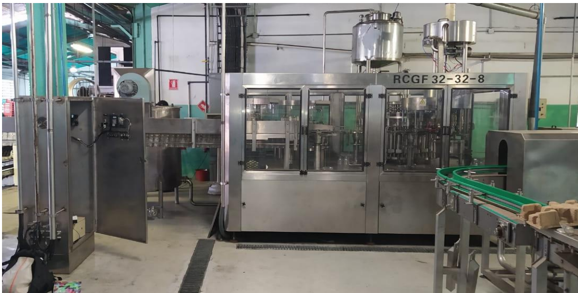
Figura 1. Máquina llenadora de botellas para el consumo humano en envases PET de la empresa Embotelladora Venezuela, S.A.
