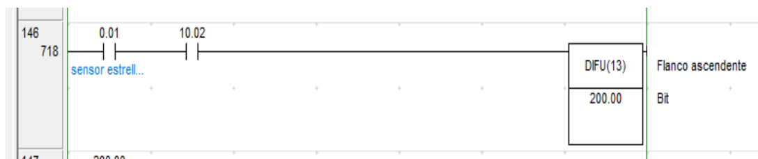
Figura 61. Sensor de estrella que coordina la entrega de la tapa a la botella.
