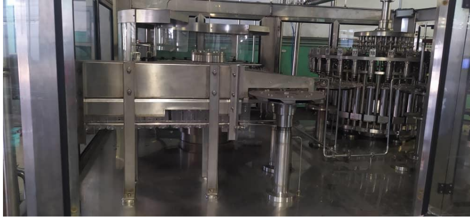
Figura 46. Boquillas de enjuague para las botellas con riel de posicionamiento a 180°.
