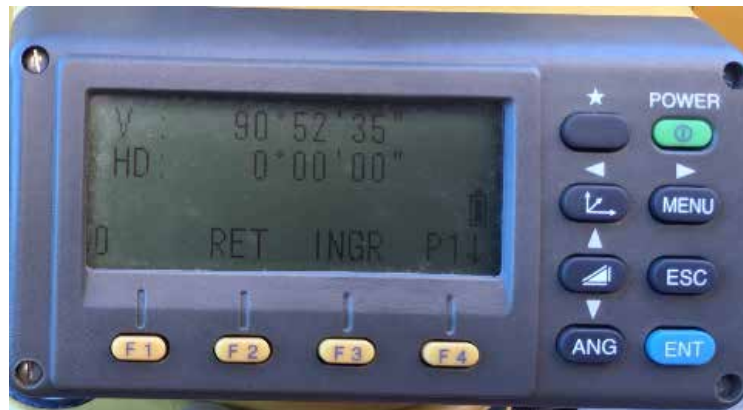
Figura 8.4: Angulo 0 en “F1” Estación Total.
