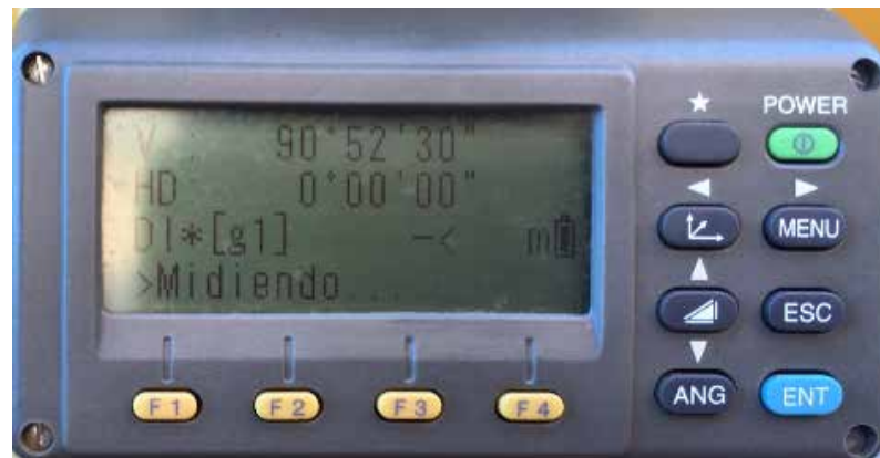
Figura 8.8: Mensaje Midiendo o desnivel de la Estación Total.
