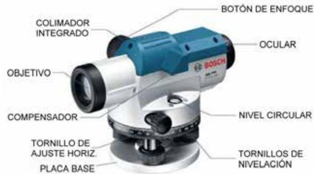
Figura 10.1: Partes del Nivel de Ingeniero
