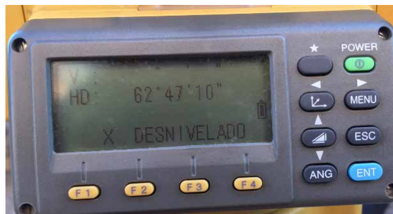
Figura 8.9: Mensaje Midiendo o desnivel de la Estación Total.
