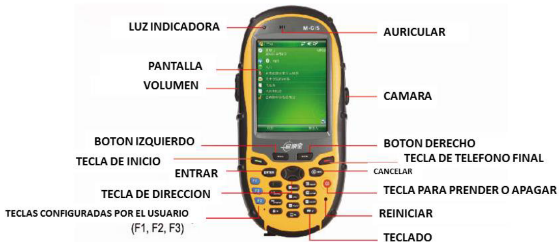
Figura 7.1: Partes del GPS
