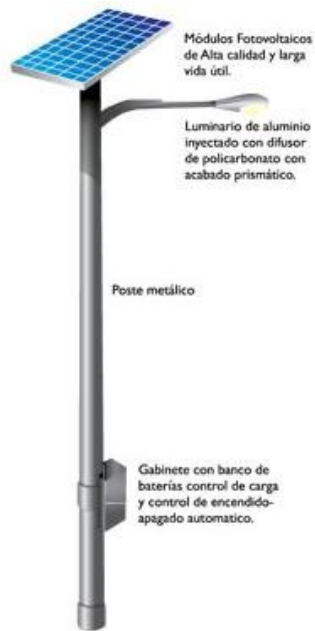
Figura 23: Poste de luz con paneles solares. Fuente: proenergy.com.mx (2017)
