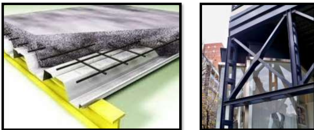
Figura 14. Losa acero con mortero de concreto, cruces de San Andrés.
