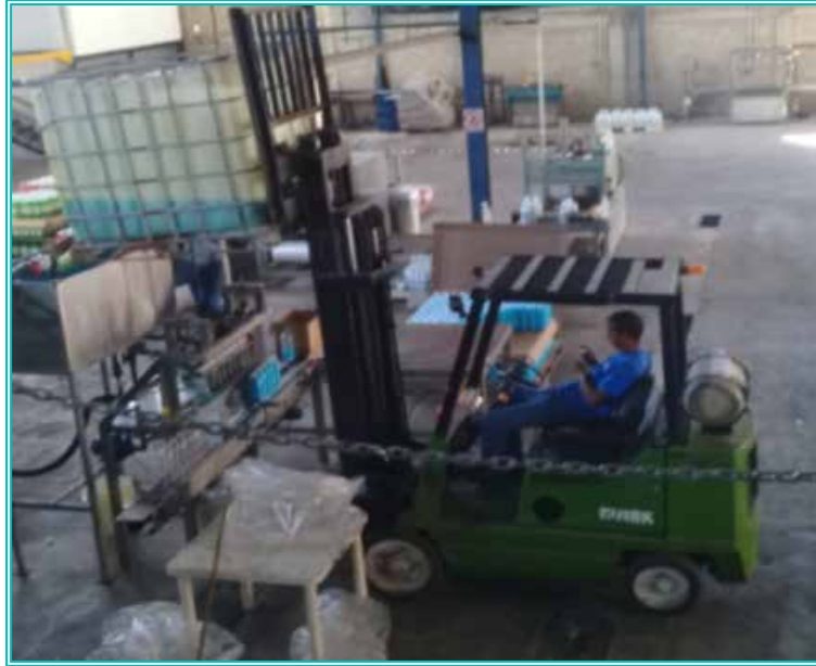
Figura 35. Descarga del suavizante del baritanque al tanque de la llenadora.
