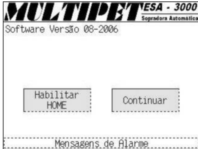
Figura 17. Pantalla antes de iniciar homing de la maquina ESA-3000 Fuente. Manual de Multipet Sopradoras (2009, p.18)
