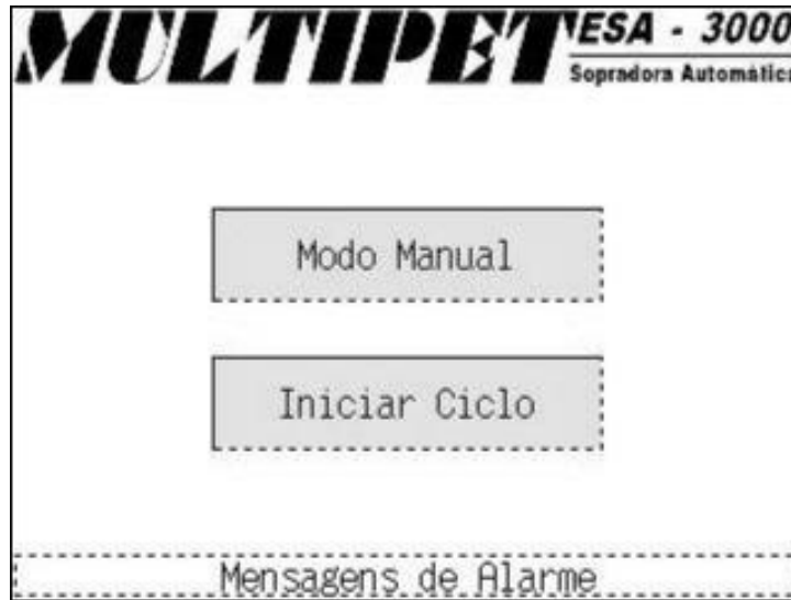
Figura 19. Pantalla de selección de modos de operación de la máquina Fuente. Manual de Multipet Sopradoras (2009, p.18)
