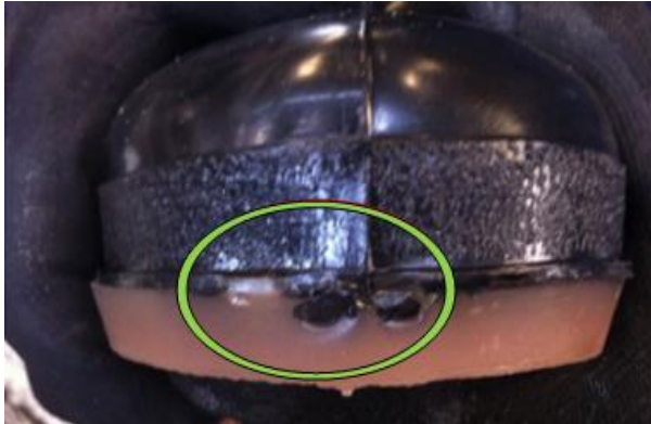
Figura 1. Exceso de rebaba en la línea de producción Jaspe.
