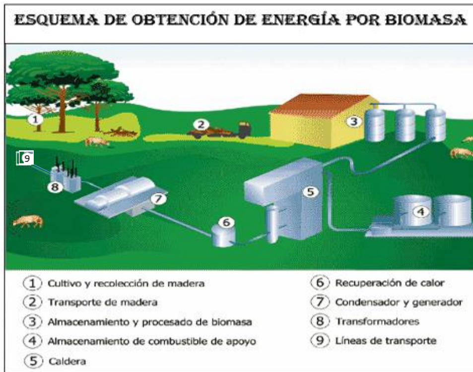
Figura 27. Esquema de obtención de la energía por biomasa Fuente: Camacho-Parra (2022)
