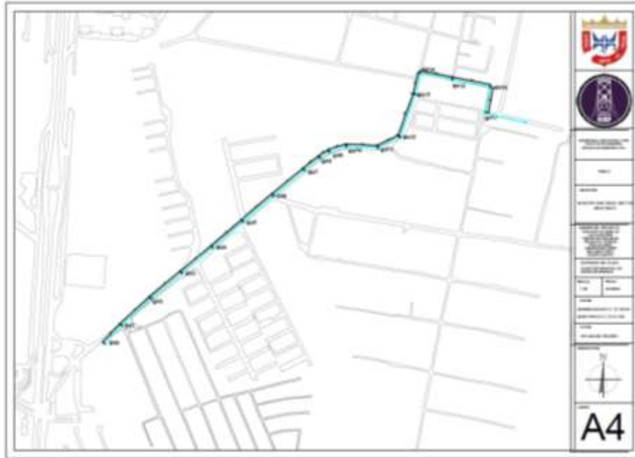
Figura 17. plano de planta de ubicación del colector de drenaje desde Los Bachilleres hasta la descarga en el río Cúpira
