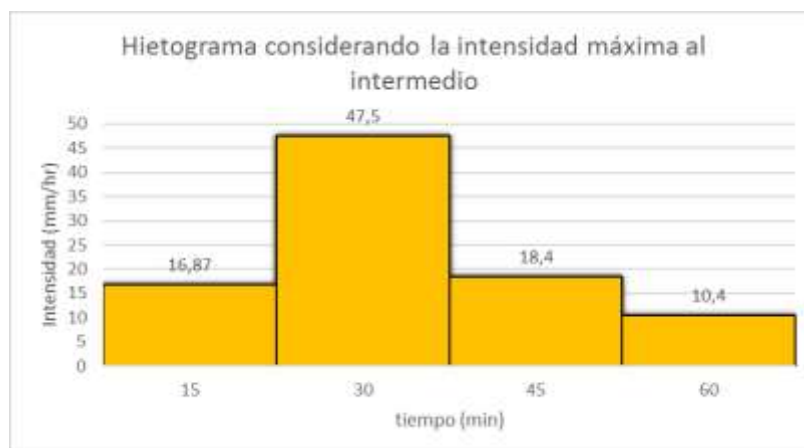
Grafico 5. Hietograma de intensidades de lluvia en mm/hr con la intensidad mayor en el medio de los intervalos de tiempo
