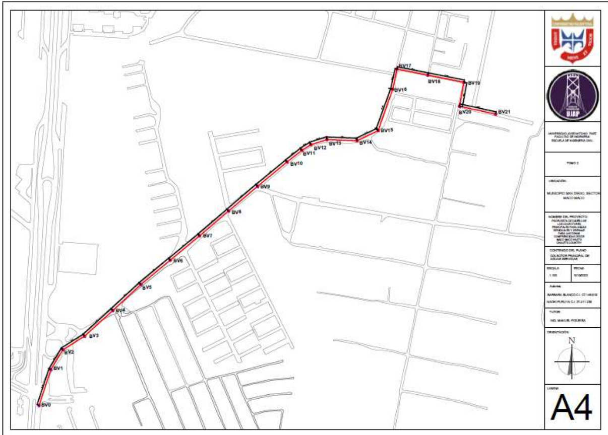
Figura 22. Plano de planta del colector de aguas servidas desde el terreno de los Bachilleres hasta la descarga en el colector principal en la Av. Don Julio Centeno
